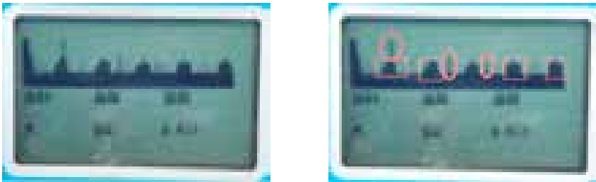
图 9 变频器干扰的回波图形
