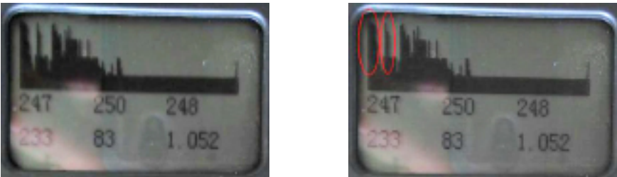
图 4 探头抬高后的回波图
